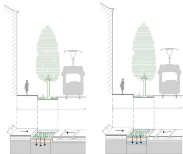
Noue végétale et jardin de pluie Beplante vallei en regentuin
