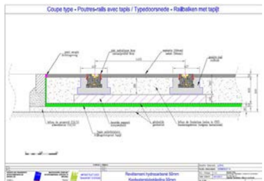
Abbeelding 187 : Geprefabriceerde railsligger (beton met rail «omwikkeld» in rubber met geluidsmat
