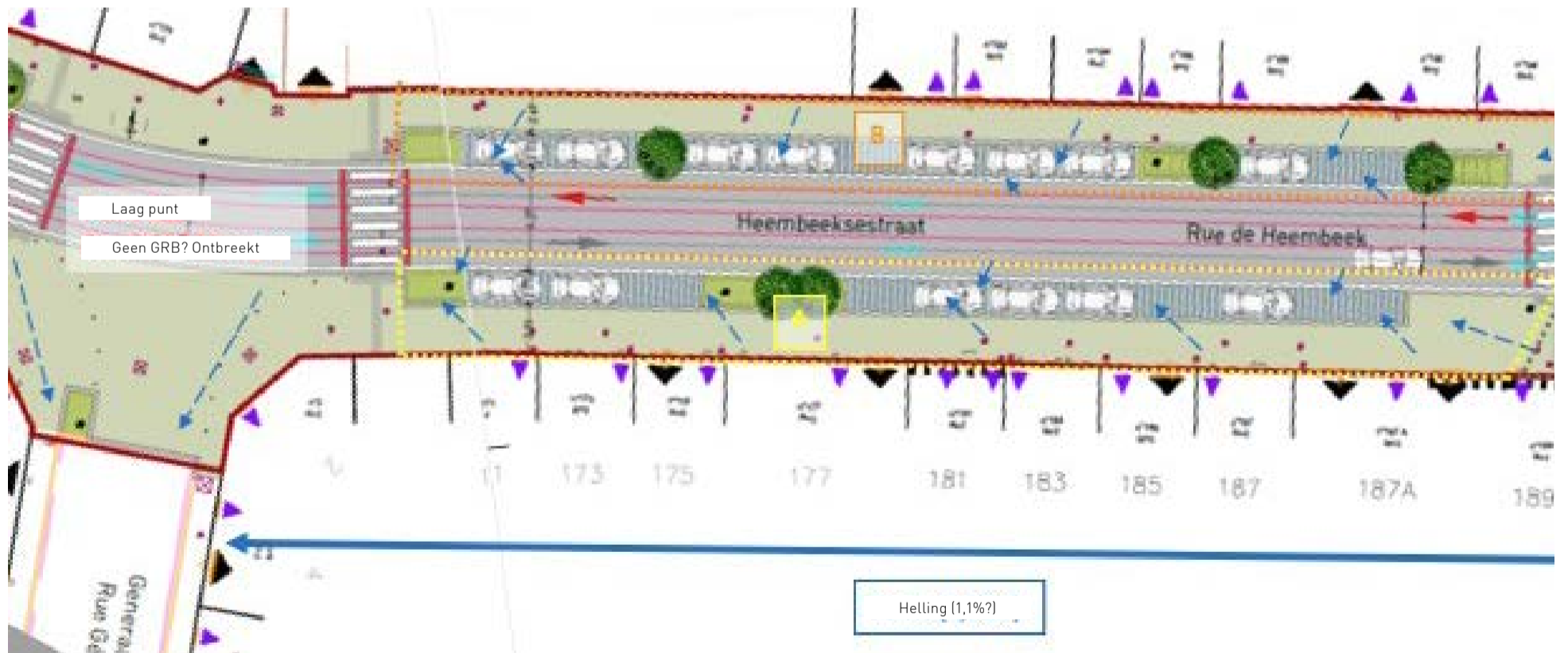
Abbeelding 201 : Principe van Geïntegreerd Regenwaterbeheer - Heembeekstraat
