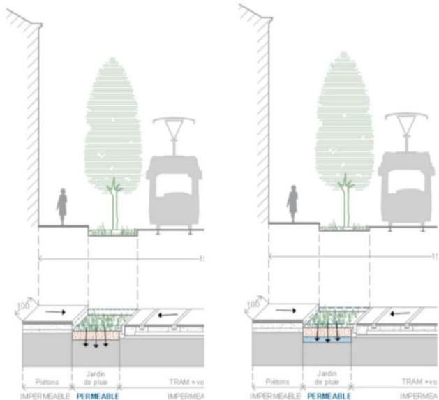
Noue végétale et jardin de pluie
